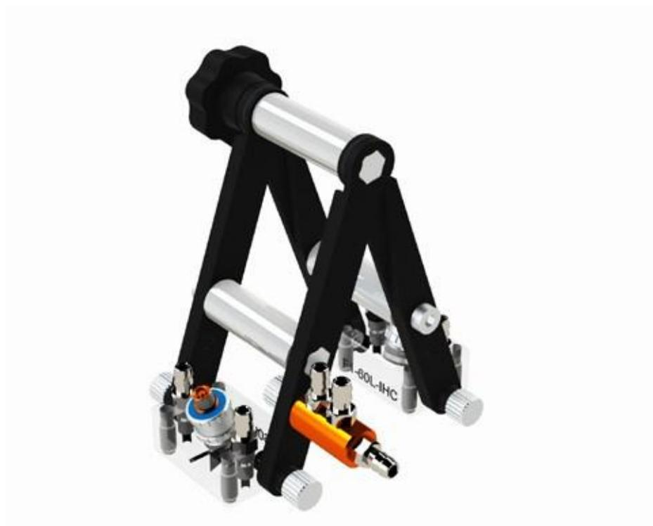
Сканер R22 идеально подходит для ручного контроля методом TOFD. Сканер состоит из ручки регулировки угла, 2-х держателей преобразователя, штуцера подачи контактной жидкости. Основной кронштейн сканера выполнен в виде ступенчатой лестницы, и с каждой стороны можно разместить преобразователь TOFD. Угол наклона основного кронштейна можно регулировать для регулировки расстояния между двумя преобразователями.
