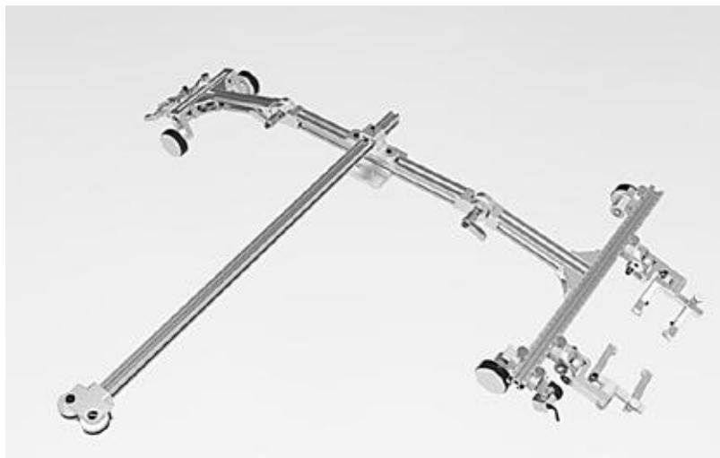
Сканер с рамой переменного диаметра R29 — это сканер для контроля трещин на фланцевых соединениях. С помощью регулировки кривизны позволяет производить контроль продольных трещин. Сканер может быть установлен с тремя наборами преобразователей, что позволяет одновременно контролировать сварные швы с помощью методов TOFD, PA и традиционного УЗ.
