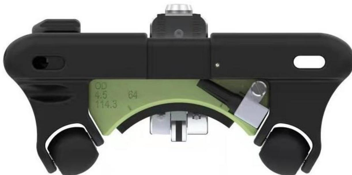
Сканер R5 предназначен для обнаружения коррозии внутренней стенки труб, отводов и гибов. Решение основано на применении гибкой фазированной решетки и концепции водяного столба. Гибкий фазированный преобразователь устанавливается в призму необходимого диаметра.
