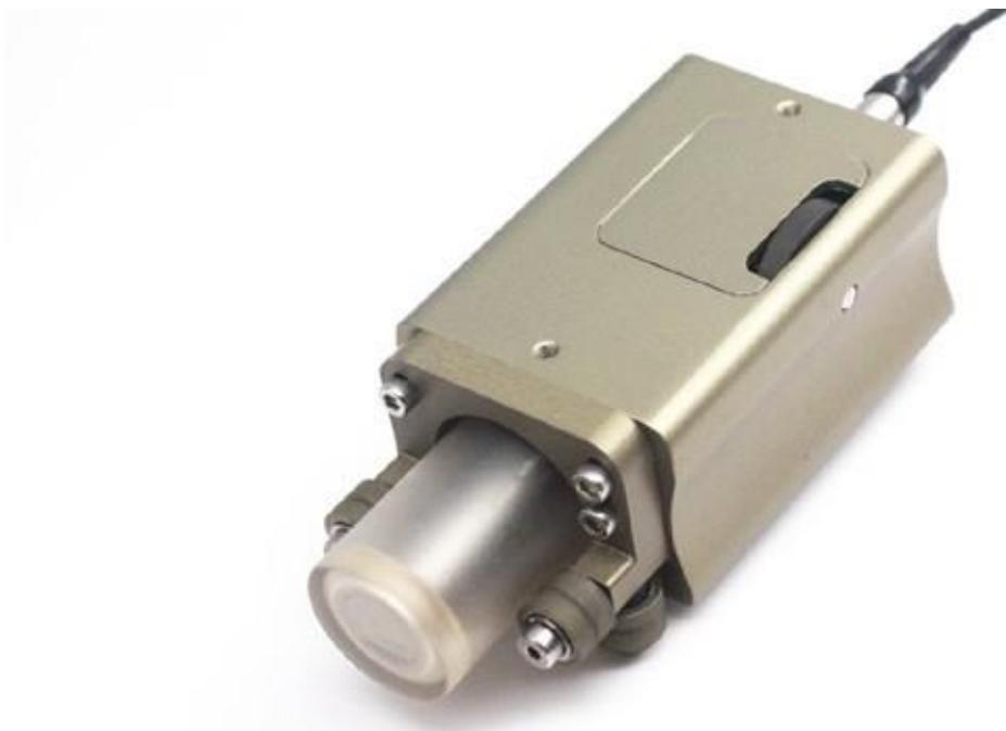
Мини роликовый сканер R4 — это портативный сканер, оснащенный фазированным преобразователем, который в основном используется для контроля композитов и других материалов с гладкой поверхностью. Шина сканера изготовлена из уникального материала, который обеспечивает превосходный акустический контакт с поверхностью, обеспечивая высокое качество ультразвукового контроля.
